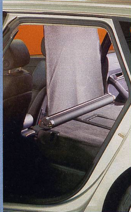
Das Trenn-Netz wird an der Seitenverkleidung oder den Lehnen montiert
