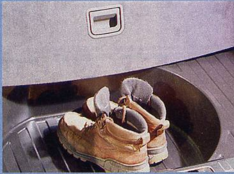
Aufklapp- und faltbarer Ladeboden mit darunterliegender Kunststoffwanne
