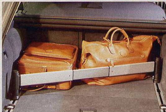
Eine optionale, in die Schienen eingerastete Teleskopstange dient als flexibler Raumteiler
