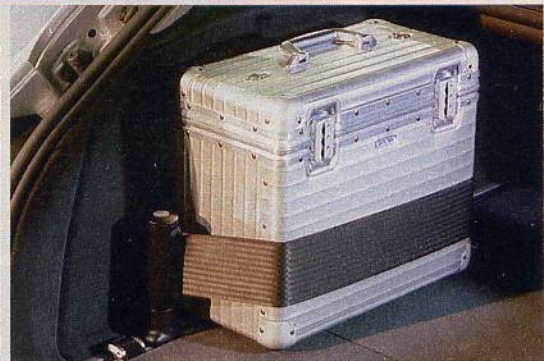
Der Spanngurt (Extra) fixiert notfalls auch unförmige Gegenstände
